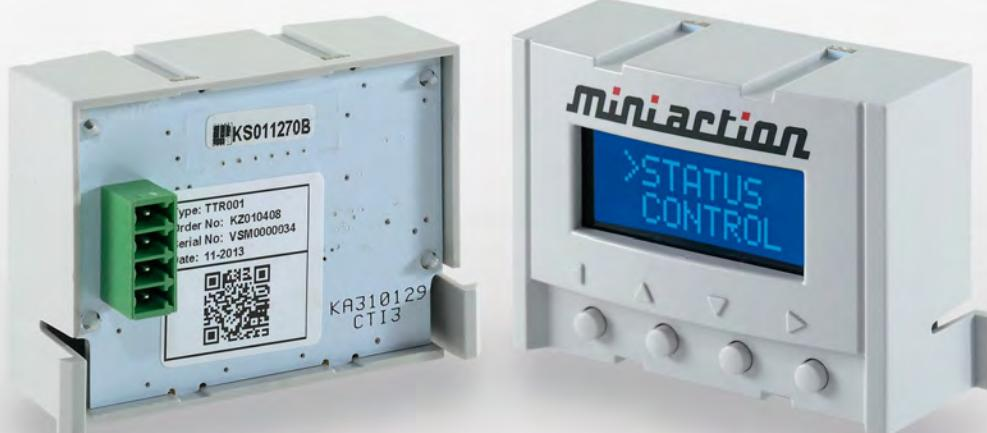
Il servoazionamento è predisposto per l'utilizzo di una interfaccia operatore rimovibile tipo TTR001, impiegabile per la parametrizzazione e per la lettura di eventuali codici di errore. Esso consta di un display alfanumerico a 2 righe da 8 caratteri e di 4 tasti direzionali; sul lato frontale dell'azionamento è previsto un apposito alloggiamento per il fissaggio a scatto e relativa porta HMI.
